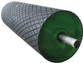
Es el componente de la cinta transportadora de mayor importancia en su funcionamiento. Su correcto dimensionamiento permite que las cintas tengan buen coeficiente de fricción, buen arco de agarre, buena tensión y mejora la alineación de las mismas. Al revestirlos con caucho e incluir rodillos de inflexión mejora la performance de todo el transportador. Se fabrican con cierta conicidad para favorecer el alineamiento de la banda.
