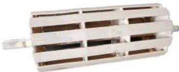
Son el inicio del ciclo de transporte. Se construyen lisos o con perfiles tipo jaula de ardilla. Se encuentran en un lugar fundamental ya que suele implicar el recorrido de tensado de las bandas (en cintas pequeñas) y se encuentran próximos a la zona de carga.
