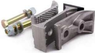
Son empalmes mecánicos modulares fabricados en inyección de aluminio para unir las dos puntas de la banda de una noria elevadora de cangilones. Están diseñados especialmente para cuidar a la banda en la zona del tambor motriz donde usualmente sufren las tensiones máximas.
